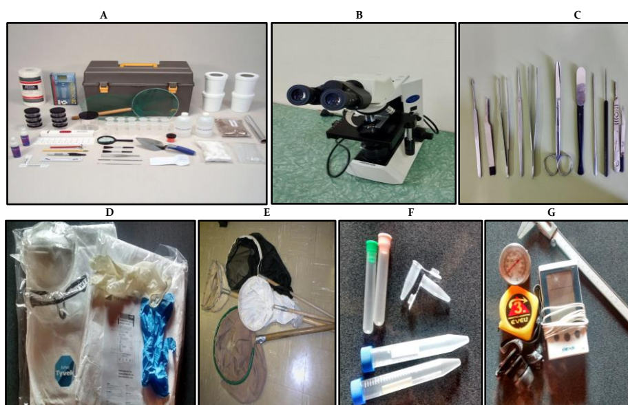
Figura 1. A) Equipo comercial para la recolección de evidencia entomológica, marca Evident. B) Lupa estereoscópica. C) Kit de pinzas para entomología. D) Elementos de bioseguridad personal: overol Tyvek, guantes de nitrilo (celeste), látex (blanco), antiparras y barbijo. E) Redes de uso entomológico. F) Frascos tapa rosca para preservar material. G) Termohigrómetro ambiental digital. Dial analógico del termómetro de punción. Linterna de vincha (mantiene la manos libres para la manipulación de los elementos de recogida durante la noche) y elementos de medición estándar (cinta métrica y calibre tipo Vernier).
